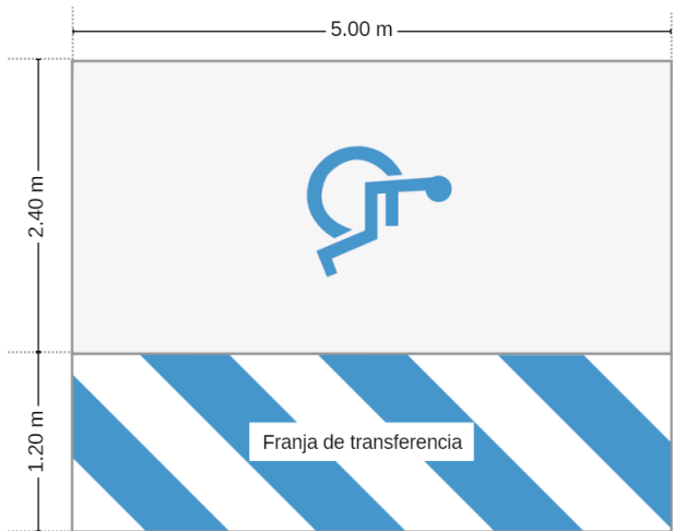
Gráfico 70. Dimensiones mínimas estacionamiento para personas con discapacidad y movilidad reducida. Referencia: NTE INEN 2248. Elaborado por: (DNIF, 2024)
