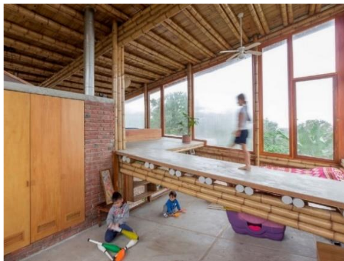
Gráfico 20. Construcción mixta en caña guadua, madera, ladrillo y hormigón; clima cálido – húmedo. Fuente: (ArchDaily, 2020)
