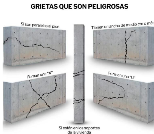
Gráfico 95. Tipos de grietas peligrosas en muros, columnas o demás elementos estructurales. Fuente: (El Universo, 2023)
