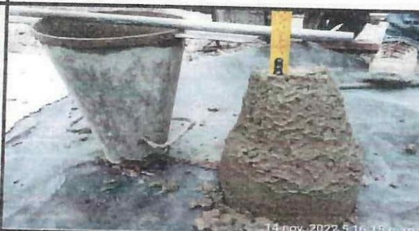
Prueba de asentamiento para fundición de contrapiso.
