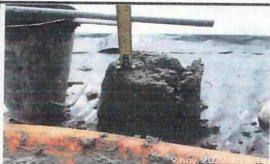
Prueba de asentamiento para fundición de contrapiso. ✓
