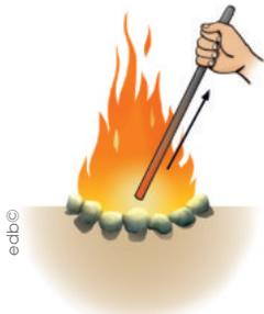
El calor se distribuye en toda la barra metálica, y hace que el extremo frío se caliente hasta el punto de soltar la barra.
