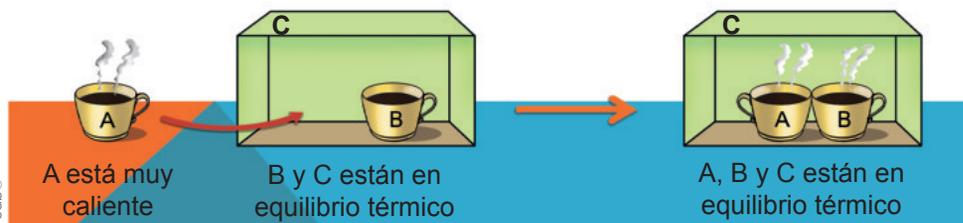
Para medir la **temperatura corporal** a través de un termómetro, primero existe transferencia de calor entre el cuerpo y el instrumento. Pasado un tiempo (mientras dura el flujo de calor), el termómetro alcanzará la misma temperatura que el cuerpo, por lo que podemos conocer la temperatura de este.
