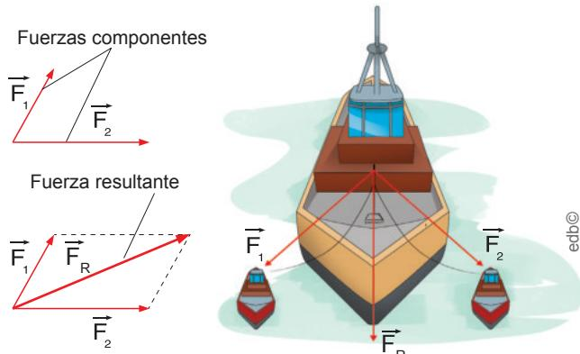
Las determinamos mediante la **regla del paralelogramo**: Por el extremo de cada fuerza trazamos una paralela al otro vector y señalamos su punto de intersección. El extremo de  $\vec{F}_R$  es el punto de intersección.
