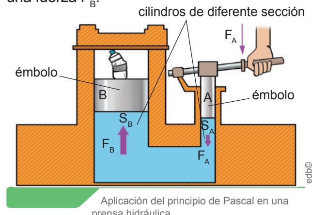
Aplicación del principio de Pascal en una prensa hidráulica
