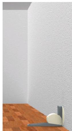
Una vez ubicado el tallímetro en el ángulo de la zona seleccionada, deslice la cinta de medición hacia arriba hasta que la línea roja en el campo de visión coincida con la línea de iniciación cero (0).
