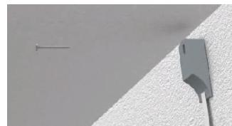
Una vez colocado el tallímetro a la altura indicada, compruebe con otro instrumento de medida la distancia correcta. Usted debe tener 2,20 metros exactos, desde el piso hasta la parte inferior de la escuadra del tallímetro.
