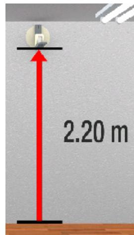
Existen tallímetros que deben ser instalados a diferentes alturas, como en este nuevo caso debe estar a 2 metros entre el piso y la escuadra del tallímetro. Verifique el instructivo que se adjunta.
