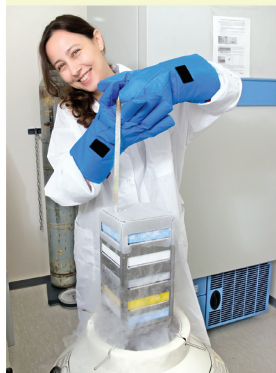
Contenedor con nitrógeno líquido para el almacenamiento de múltiples muestras biológicas.
