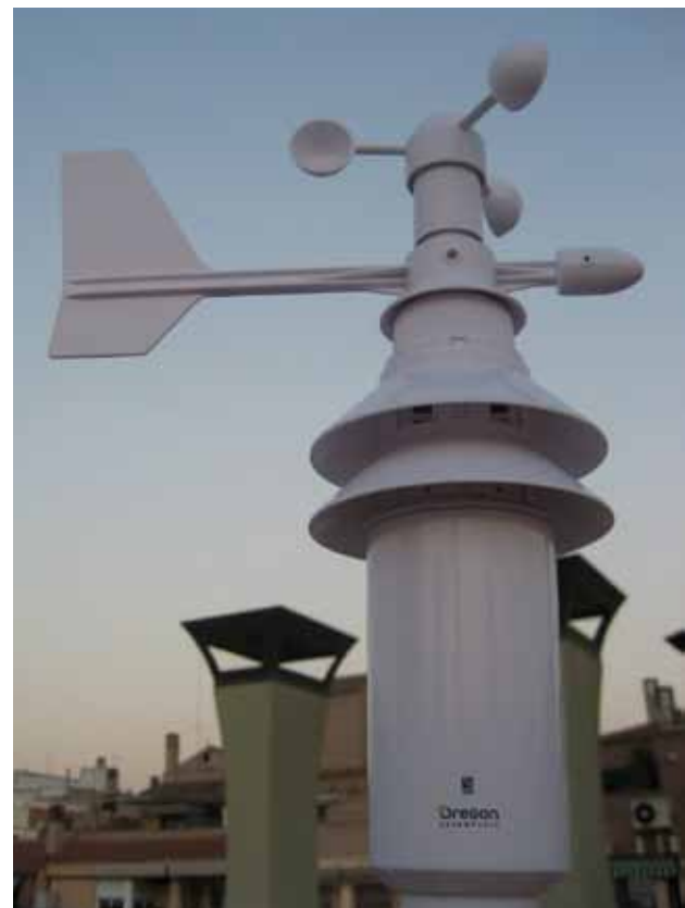
Estación meteorológica de Erihela. España. con sus instrumentos de medición.
