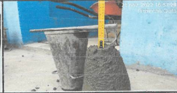
Prueba de asentamiento para fundición de vigas en eje A - G.
