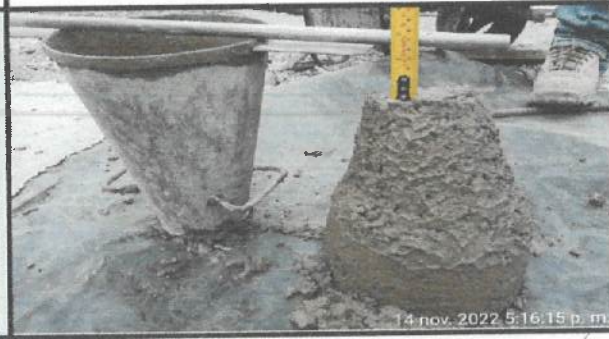
Prueba de asentamiento para fundición de contrapiso.
