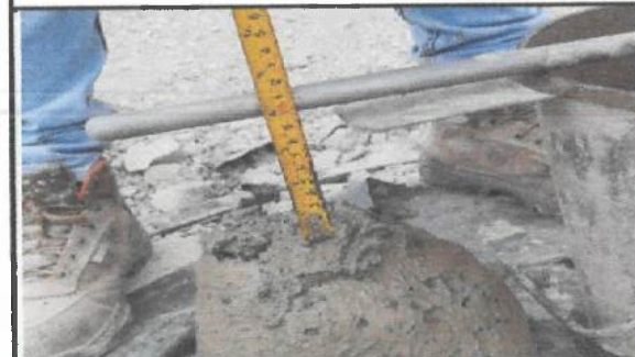
Prueba de asentamiento para fundición de columnas.
