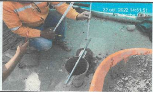
Prueba de asentamiento
