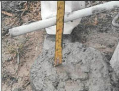
Prueba de asentamiento de hormigón en concretera
