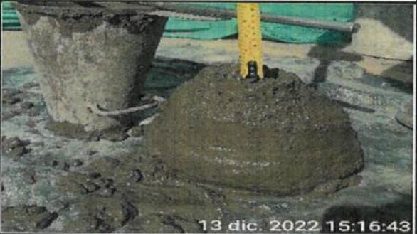
Prueba de asentamiento para fundición de columnas en eje A-M (1), bloque 19 aulas nuevas.
