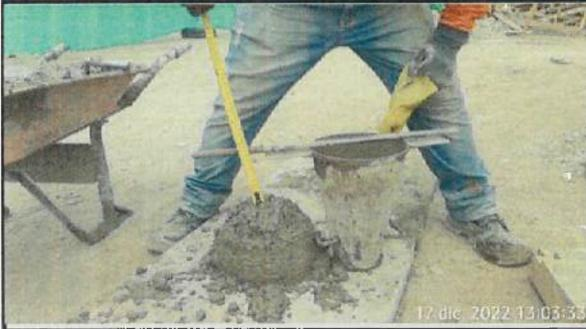
Prueba de asentamiento para fundición de contrapiso en bloque 19 panadería.
