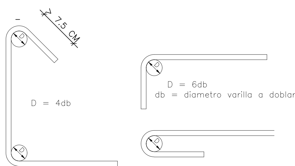
DOBLADO DE GANCHOS ESTANDAR PARA ESTRIBOS
