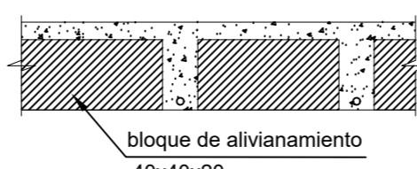
CORTE LOSA e=25cm ESCALA 1:25
