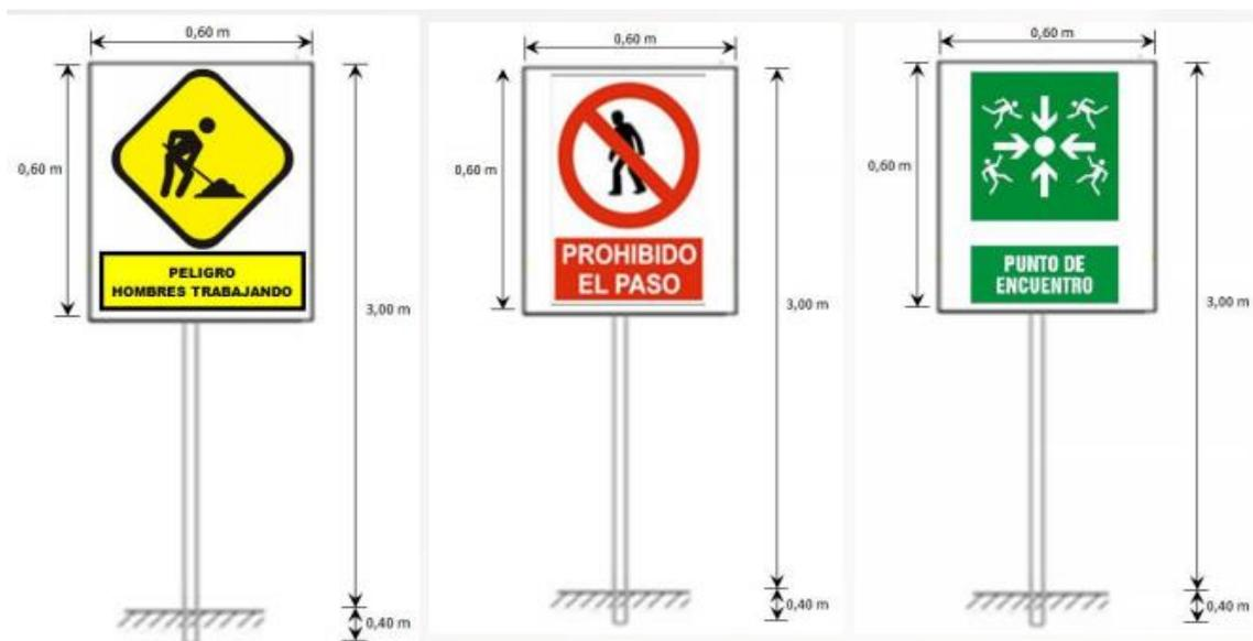
Las señales a emplearse deben ser de un material resistente a las condiciones climáticas y acorde a los trabajos de obra de que se encuentren ejecutando, siendo el fiscalizador de la obra quien apruebe las mismas. Serán de forma cuadrangular de 0,60m y los soportes de tubo galvanizado de 2 pulgadas, plancha de tool galvanizado de 1/18", tendrán una altura aproximada de 3.00 m, revestida de pintura anticorrosiva y se enterrarán a unos 0.40 metros.
