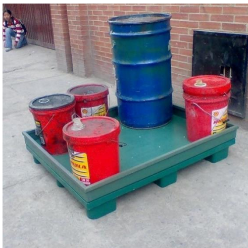
Foto No. 1: Ejemplo de cubeto para residuos peligrosos
