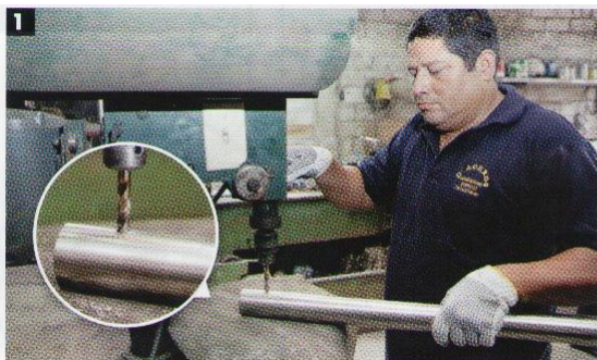
Perforación del tubo superior.
