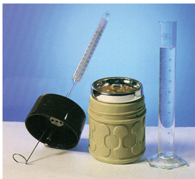
Figura 6. El calor se mide mediante un calorímetro y se expresa en unidades denominadas calorías.
