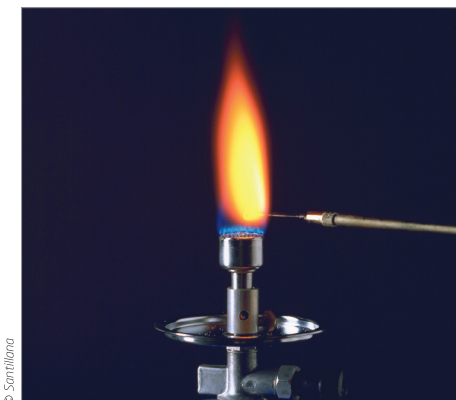
Fig. 6.8. Coloración de la llama producida por sales de sodio.
