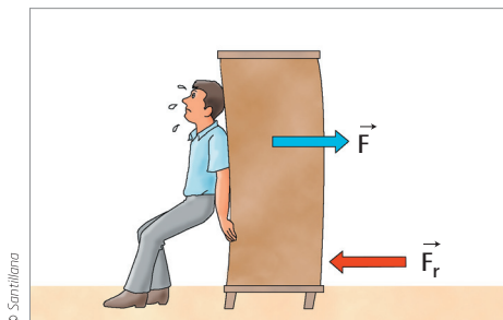
Fig. 4.29. Cuando un objeto se encuentra en reposo, actúa la fuerza de rozamiento estático.
