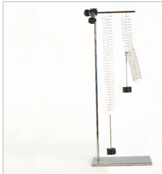
Fig. 4.4. Los efectos de las fuerzas dependen del punto de aplicación.
