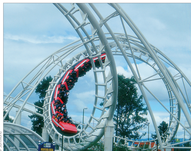
Fig. 5.23. La energía potencial cuando el carrito está en lo alto se transforma en cinética a lo largo de la trayectoria.
