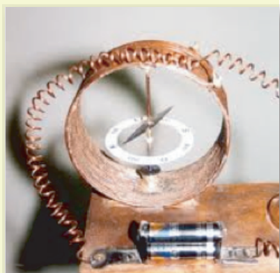
Aparato usado por Oersted para demostrar la relación entre magnetismo y electricidad.
