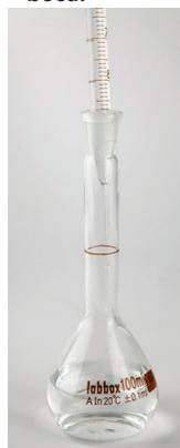
Con la pipeta se añade con cuidado el ácido al agua del matraz.
