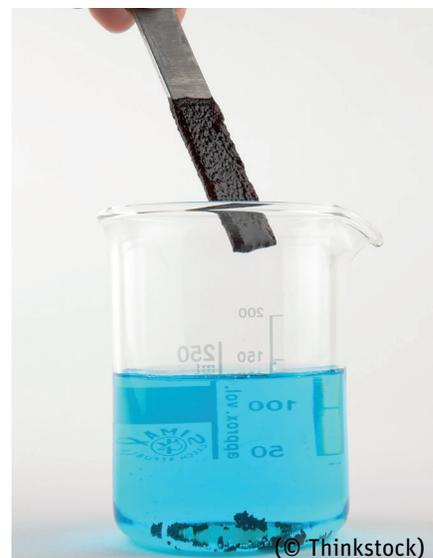
El Zn se oxida y los iones Cu<sup>2+</sup>(ac) se reducen a Cu metálico, que se deposita sobre la barra de cinc.
