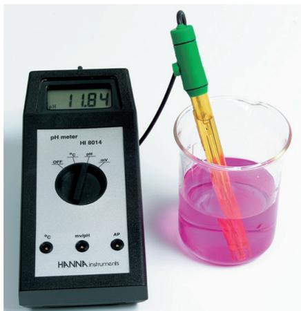
El pH de una disolución puede medirse directamente en el laboratorio usando un aparato denominado pH-metro. Si introducimos los electrodos en la disolución, podemos leer el valor de su pH.
