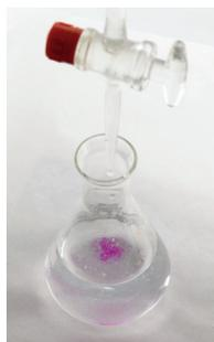
2. En una bureta se pone la base, de concentración conocida (**disolución patrón**), y se va añadiendo sobre el ácido lentamente, hasta que el indicador cambia de color.
