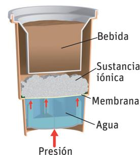
Las bolsas de frío, o las bebidas autoenfriables, llevan una sustancia cuya disolución en agua es endotérmica, como el  $\text{NH}_4\text{NO}_3$ . Al entrar en contacto con el agua, estas sustancias absorben calor y enfrían lo que tienen a su alrededor.
