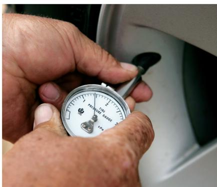
Al conectar el manómetro a una rueda, medimos la presión del aire en su interior y, si es preciso, añadimos o dejamos que salga aire. Los manómetros pueden ser digitales o analógicos. (© Thinkstock)
