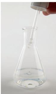
1. Se mide con precisión un volumen cualquiera del ácido (unos 15 mL) que se quiere valorar, y se vierte en un matraz erlenmeyer al que se han añadido unas gotas de indicador.
